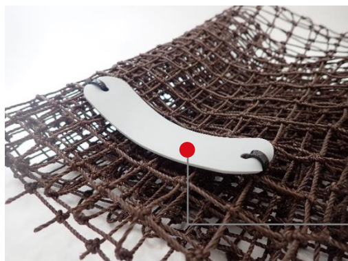
工事現場のネットに RFIDタグを取り付けている様子
