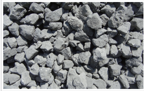
道路の路盤材用碎石にリサイクルされた脱水汚泥
