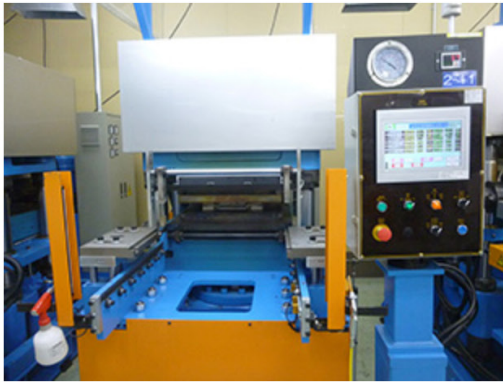
福島工場250トンプレス機にジャケットを装着
