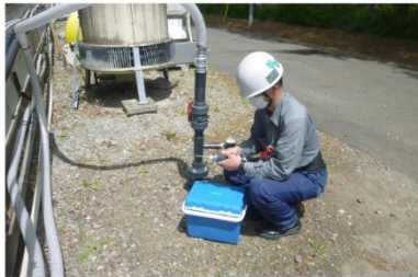
ガス濃度調査の様子
